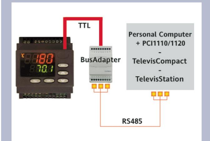
Der Anschluss an die Fernsteuerungssysteme Televis kann über den seriellen Port TTL (unter Verwendung des Schnittstellenmoduls TTL- RS 485 BUS ADAPTER 130 oder 150) oder bei den entsprechend vorgerüsteten Modellen (DR4022) durch Direktanschluss RS-485 erfolgen. Für die entsprechende Konfigurierung des Gerätes muss man die Registerkarte mit dem Label „Add“ aufrufen und die Parameter „dEA“ und „FAA“ verwenden.
