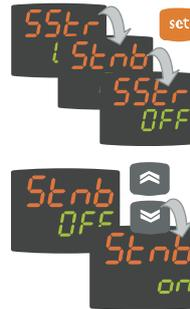
Es werden das Label und der aktuelle Status der Funktion angezeigt. Zum Durchlaufen aller vorhandenen Funktionen die Taste 'set' drücken.
